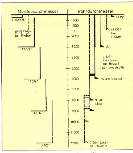
Abb. 3 Für die KTB-Hauptbohrung geplantes Bohr- und Verrohrungsprogramm
