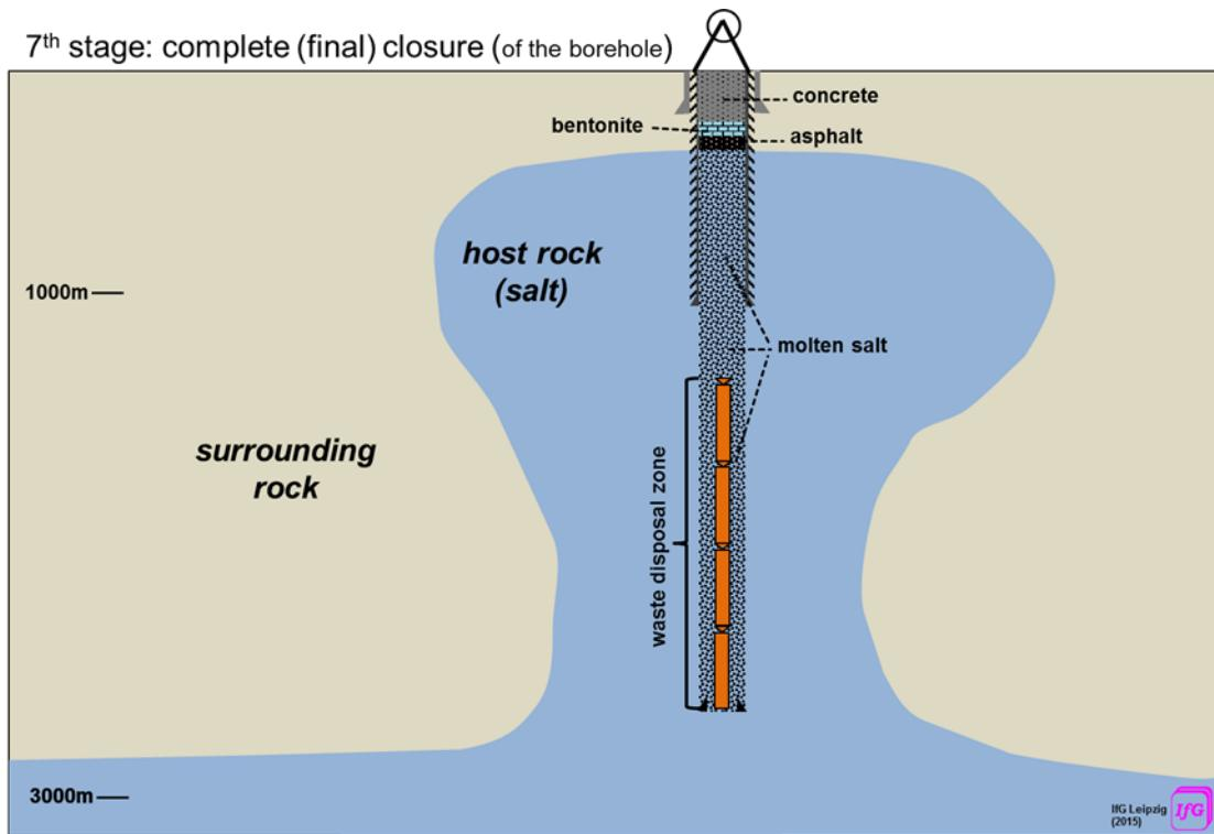
**Abb. 3.1.8** Schema zur tiefen Bohrlochlagerung im Salzgestein mit Salzschorze als Verfüll- und Verschlussmaterial
