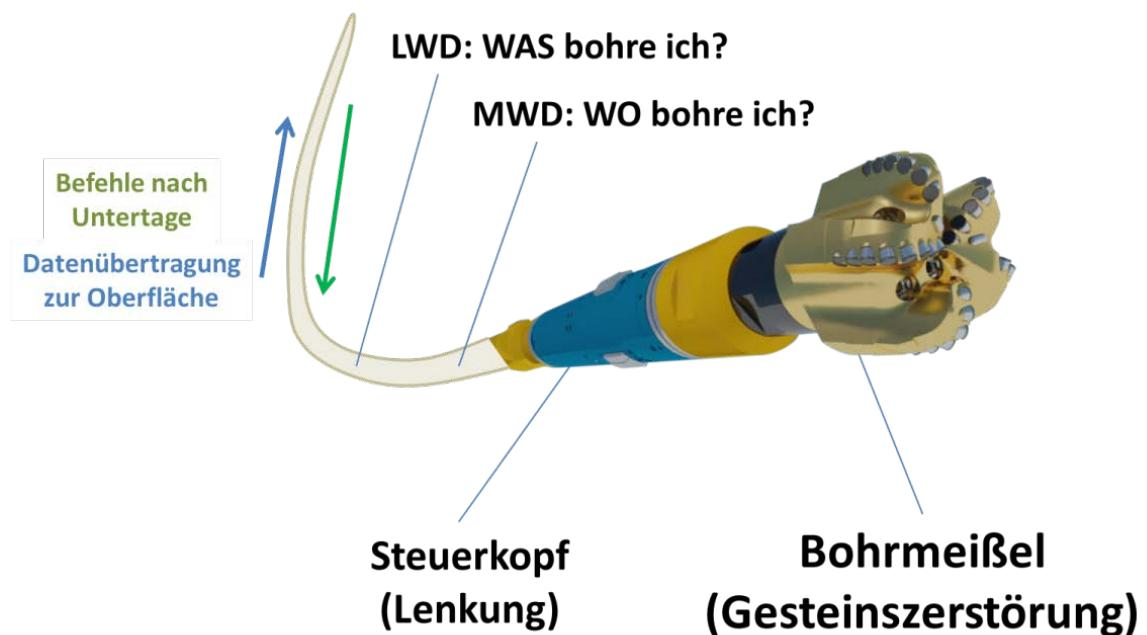
**Abb. 4.1.9** unteres Ende einer Bohrgarnitur
