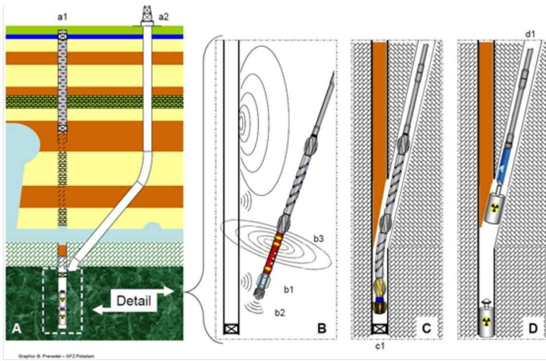
**Abb. 7.4.2** (A) Auffinden einer permanent verschlossenen Endlagerbohrung (a1) durch eine Bergungsbohrung (a2), vergleichbar einer Entlastungsbohrung in der Öl & Gas Industrie zur untertägigen Reparatur von Blow-out Havarien.
