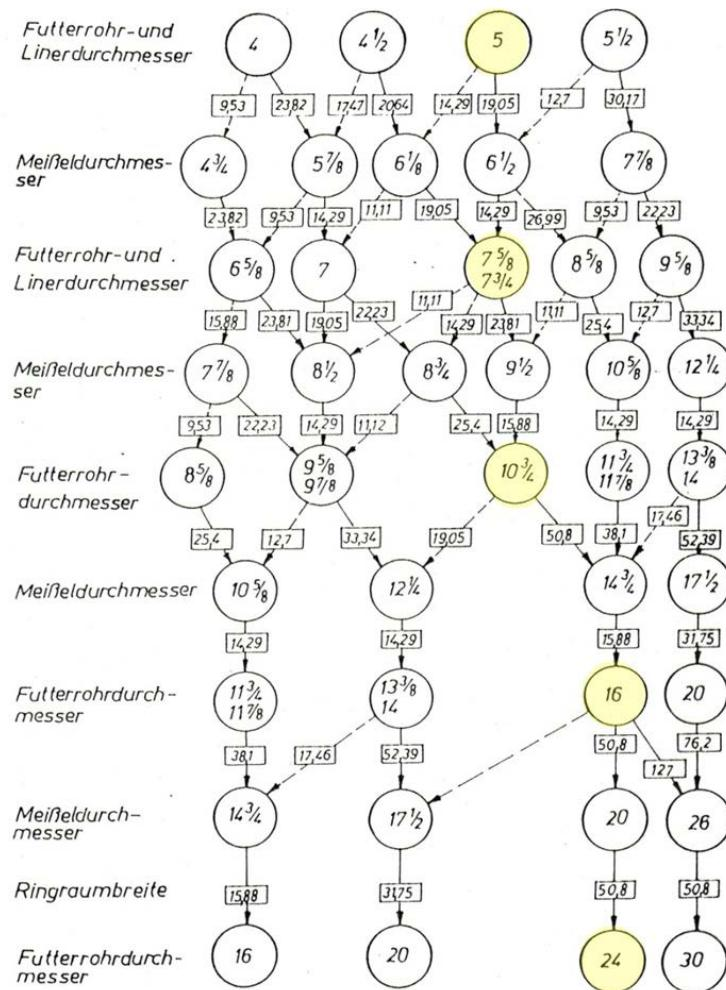
**Abb. 4.1.6** API-Durchmesserreihe für Rohre und Meißel
