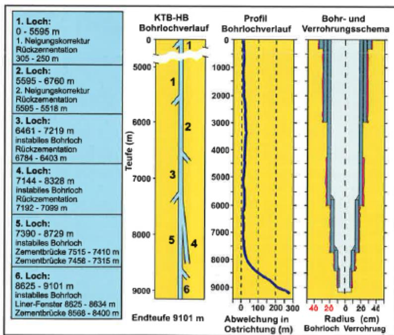
Der Bohrlochverlauf mit Neigungskorrekturen und Havarien, das Profil des Bohrlochverlaufs mit dem senkrechten Abschnitt und der starken Krümmung im unteren Teil sowie dem Verrohrungsschema der fertigen Hauptbohrung
