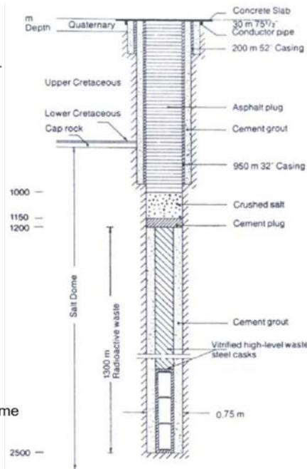
**Abb. 3.1.4 Konzept HLW-Bohrlochlagerung in tiefen Bohrlöchern in einem Salzstock /NIREX 04/**
