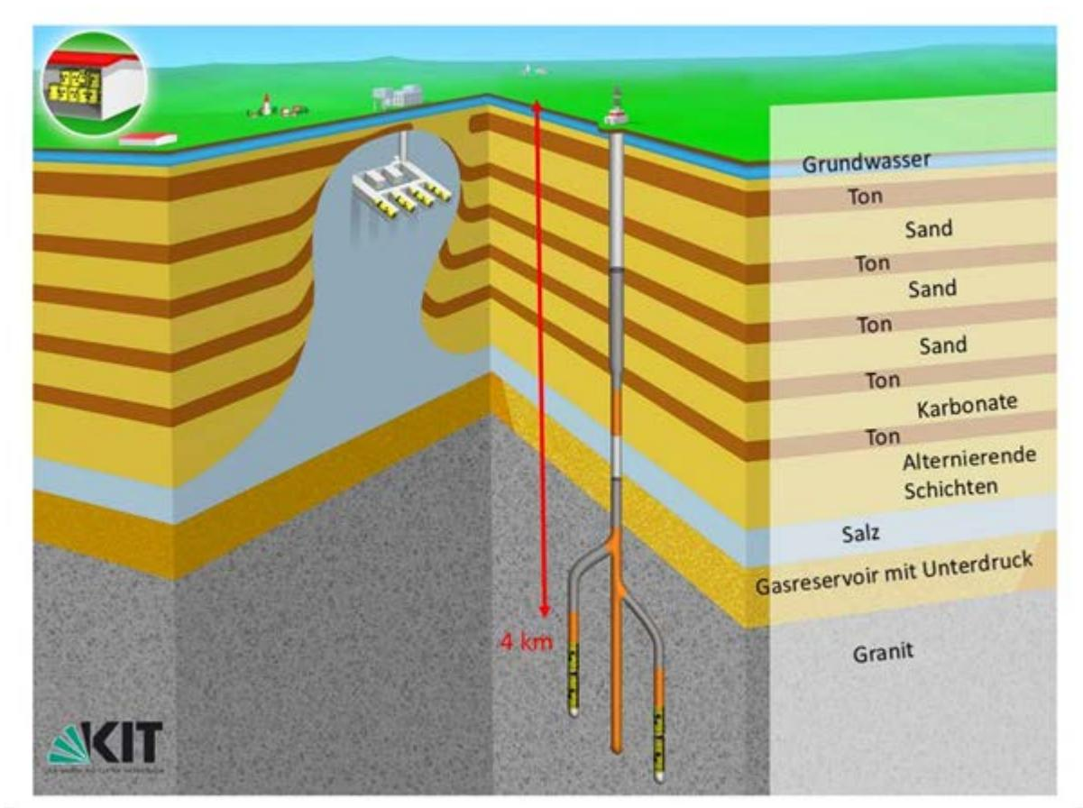
**Abb. 7.4.1** Endlagerung in tiefen Bohrungen erlaubt die Nutzung eines Multibarrierensystems: Granit wegen Stabilität, Tone und Salze aufgrund ihrer Undurchlässigkeit als geologische Barrieren und ggf. zusätzlich ein leergefördertes Reservoir als physikalische Barriere um aufsteigende Gase sicher und in großer Entfernung vom Schutzgut Mensch/Trinkwasser einzuschließen.
