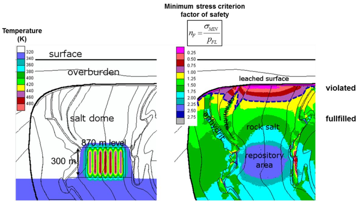
**Abb. 3.1.3** Thermo-mechanische Berechnung 30 Jahre nach Einlagerung Wärme entwickelnder radioaktiver Abfälle in 300 m tiefen Bohrlöchern
