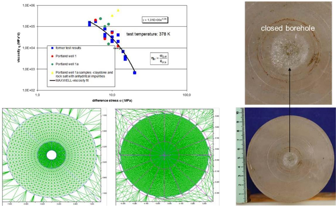
**Abb. 3.1.6** visko-plastische Berechnung zum Selbstverschluss einer offen stehenden Bohrung in 3000 m Tiefe im Steinsalz und experimentelle Versuchsergebnisse
