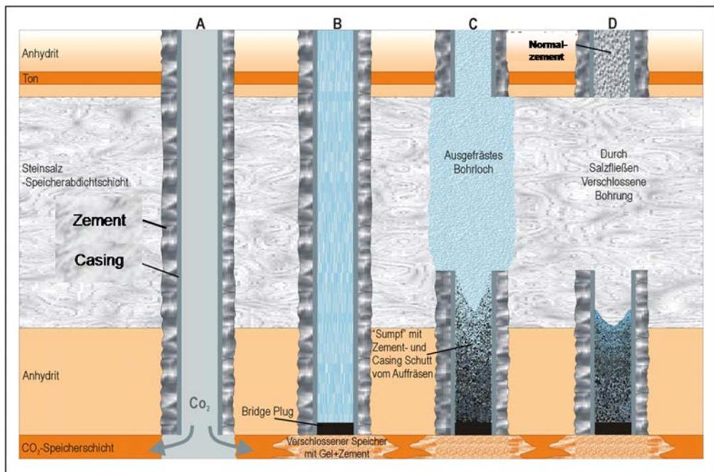
**Abb. 3.1.7** Selbstverschluss nach Ausfräsen eines Fensters im Casing und Zement einer Bohrung in einer Salzgesteinsformation in großer Tiefe /KRE 09/
