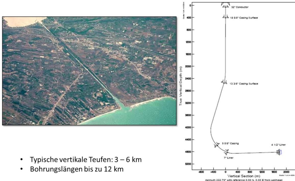
**Abb. 4.1.7** Dimensionen typischer Öl- und Gasbohrungen
