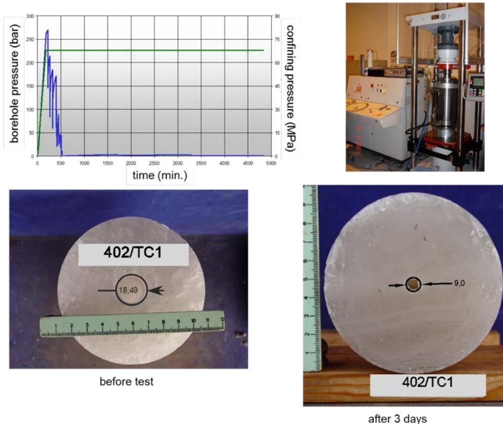
**Abb. 3.1.5** Bohrlochkonvergenz bei einem in 3000 m Tiefe wirkenden Gebirgsdruck von 68 MPa und einer Temperatur von 115 °C im Salzgestein
