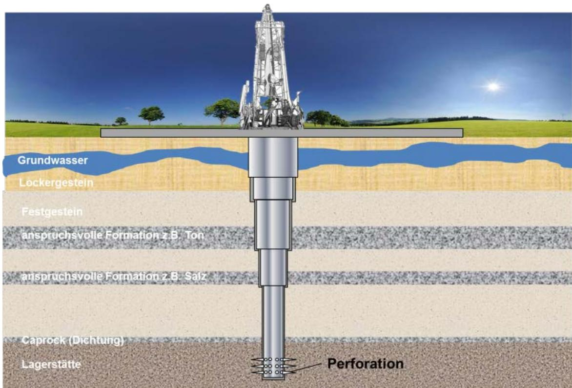
**Abb. 4.1.4** fertig verrohrte Bohrung (Quelle: Reich)
